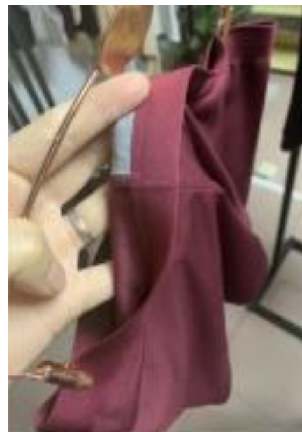
图2 热贴合技术在无缝内衣各部位的应用
