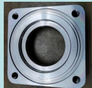
图3 绘制端盖零件图及加工后的端盖零件
