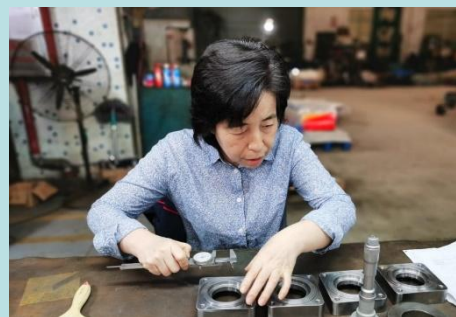
图3 绘制端盖零件图及加工后的端盖零件
