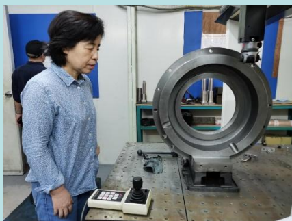
图2 用三坐标测量仪对零件进行测量
