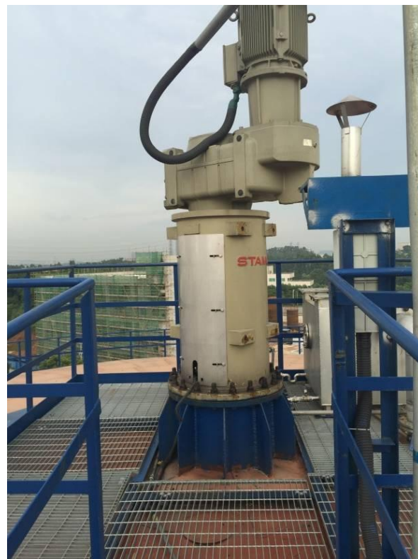
图2 发酵罐顶部搅拌器
